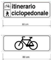
Fig 4: Possibile cartello di pericolo generico (fig. II, art 103 DPR 495/92, con pannello integrativo, (mod II 6 art 83 DPR 495/92) da porre su strada a viabilità ordinaria per segnalare la frequente e probabile presenza di ciclisti, ovvero dell' itinerario ciclopeditone (Eventualmente da utilizzarsi abbinato a limite di velocità 30 o meno vedi Tab 6c)
