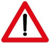
Fig 4: Possibile cartello di pericolo generico (fig. II, art 103 DPR 495/92, con pannello integrativo, (mod II 6 art 83 DPR 495/92) da porre su strada a viabilità ordinaria per segnalare la frequente e probabile presenza di ciclisti, ovvero dell' itinerario ciclopeditone (Eventualmente da utilizzarsi abbinato a limite di velocità 30 o meno vedi Tab 6c)
